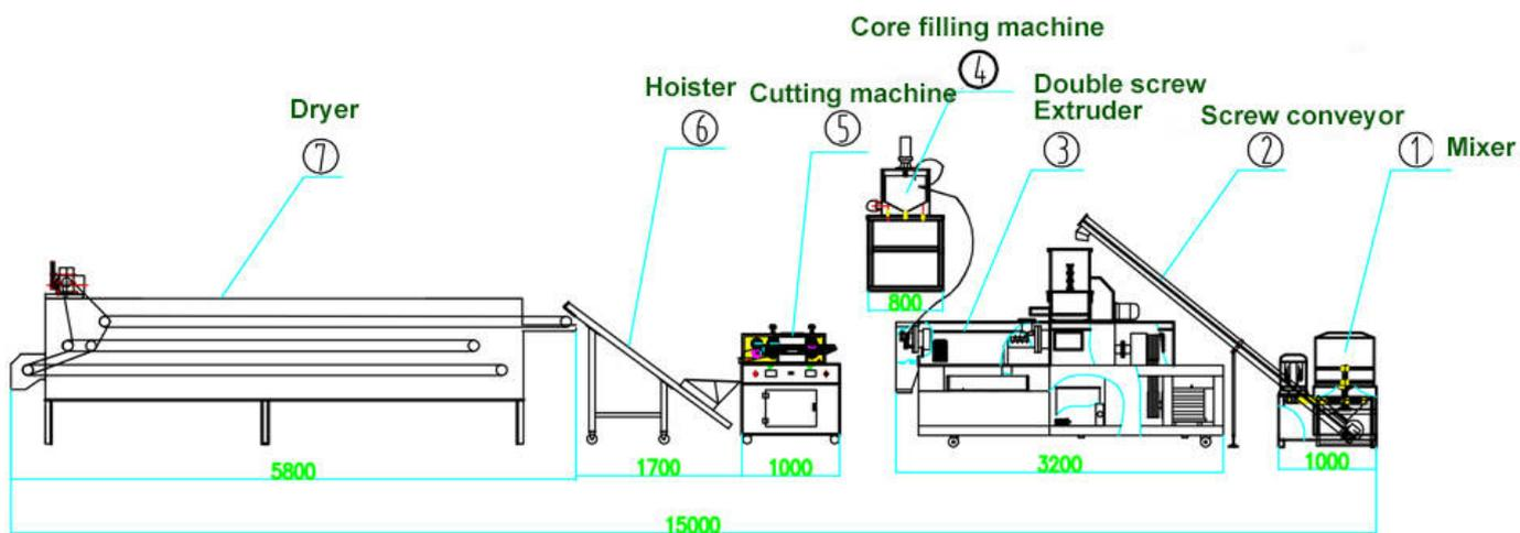
Sistema de mistura --- Sistema de extrusão ---- Sistema de corte --- Sistema de secagem --- Sistema de aromatização
