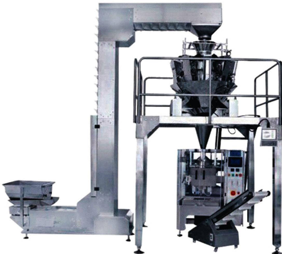
**DIBUJO DETALLADO DEL EMBALAJE DE PESADORA MULTI CABEZALES**
