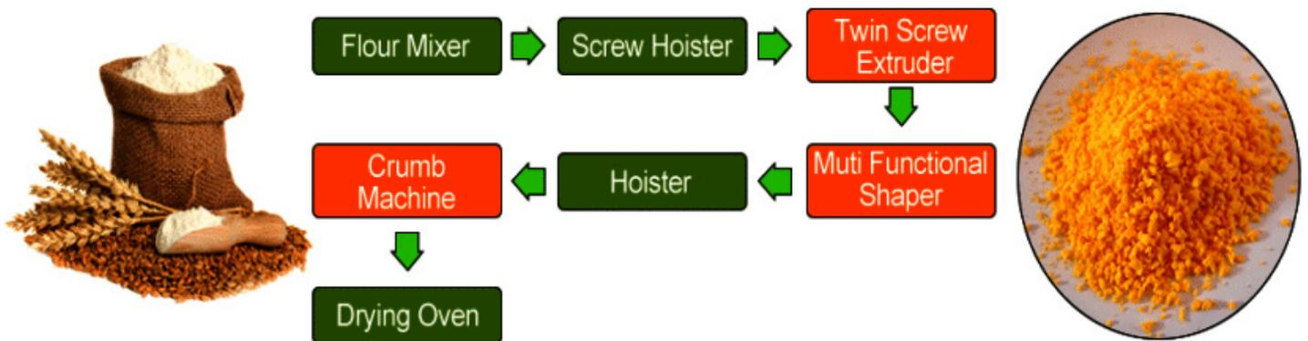
Diagrama de flujo de diseño de la trituradora de migajas de pan
